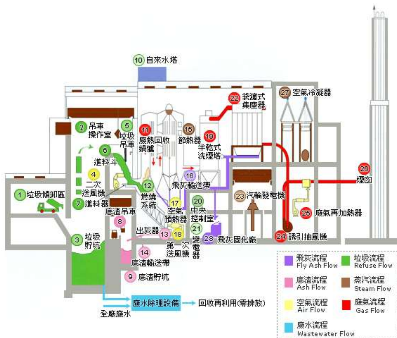
圖 1 利澤垃圾資源回收(焚化)廠處理流程圖
