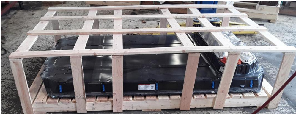
圖 11、電動汽車動力電池貯存範例
