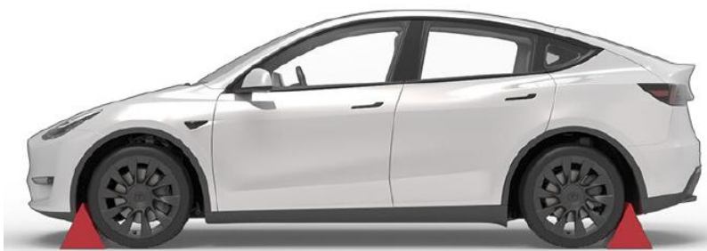
圖 9、以車輪擋抵住輪胎之示意圖
