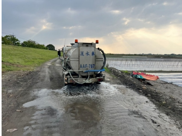
圖1.2-7 河川揚塵灑水洗街防制
